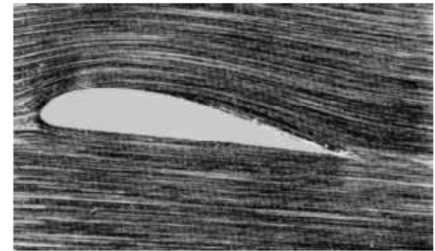
Figuur 2.21: Stroming om een vleugel.
